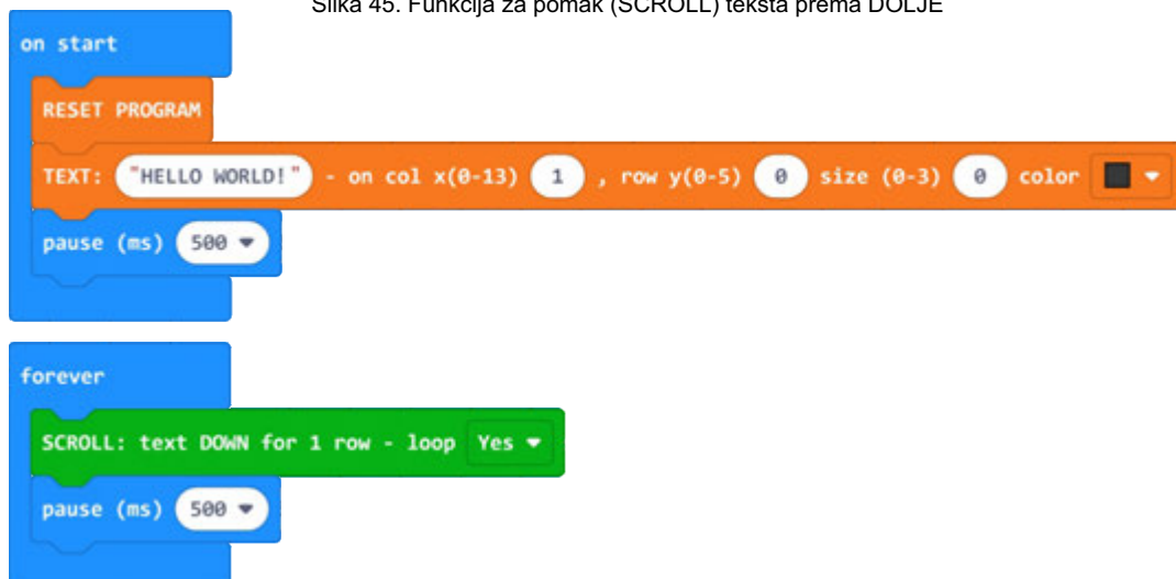
Slika 46. Primjer vertikalnog pomaka teksta
