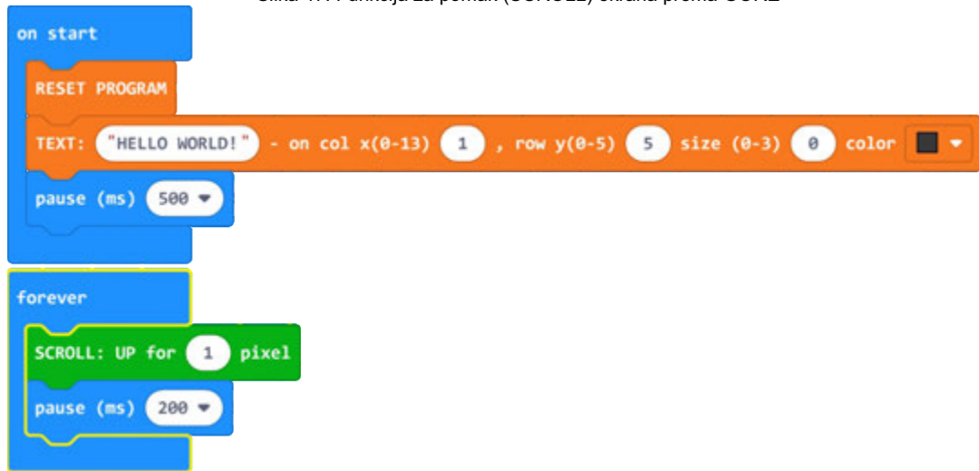
Slika 48. Primjer pomaka ekrana za jedan piksel prema GORE
